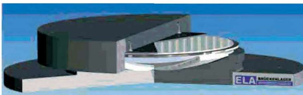
Secțiune printr-un lagăr sferic Tf
