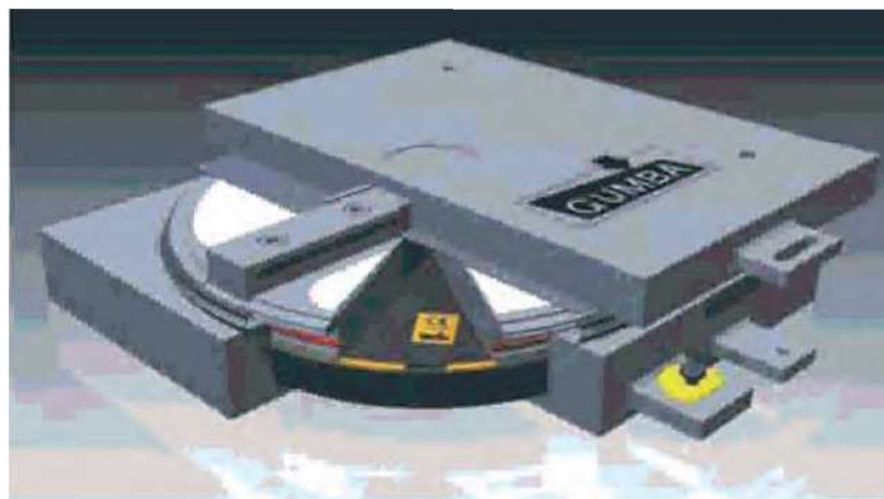
Secțiune printr-un lagăr recipient Tge
